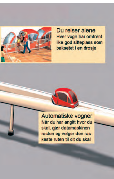
En sportaxi er basert på et stort antall små vogner som automatisk bringer sine passasjerer direkte til ønsket stasjon, uten stopp underveis. Illustrasjon: Taxi 2000/Samferdsel.
